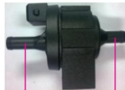
接进气歧管 接空气滤清器
