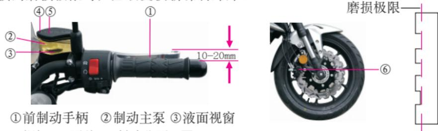
①前制动手柄 ②制动主泵 ③液面视窗
