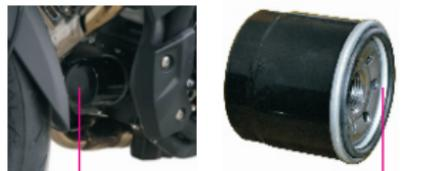
机油滤清器 图33 密封圈
