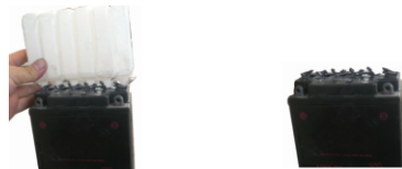
图49-1 ①蓄电池 ②蓄电池盖 ③瓶装电解液
