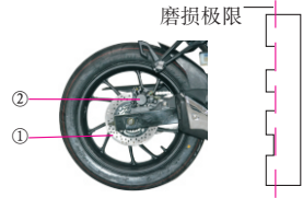
①后制动盘②后制动分泵 图44
