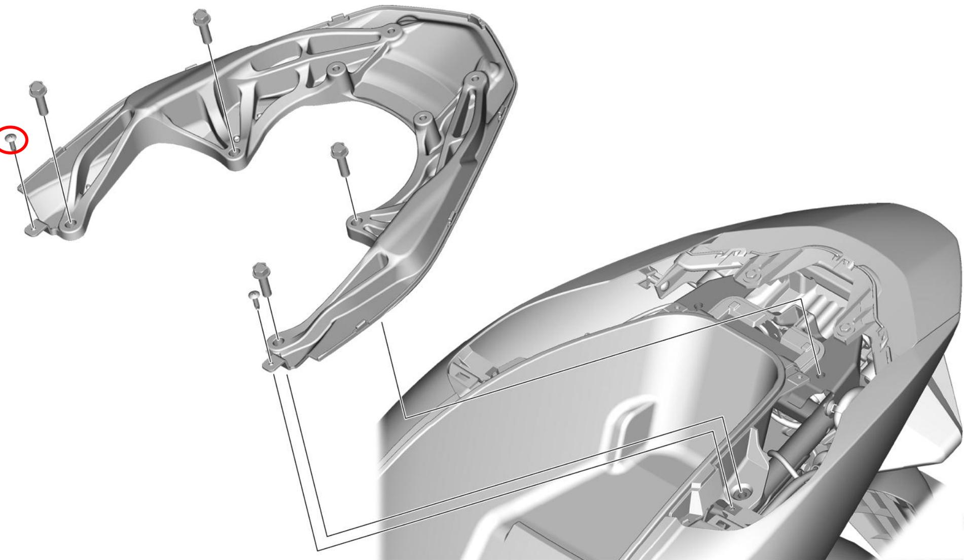
工具：十字螺丝刀、12#T形状套筒
