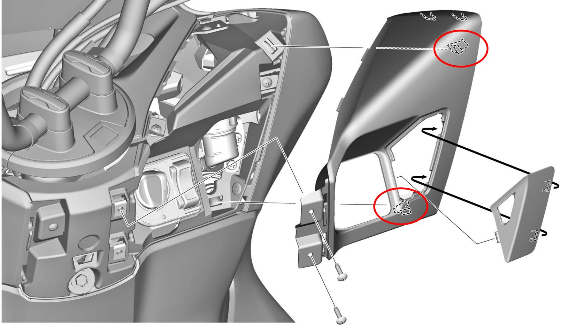
工具：十字螺丝刀、塑料刮板
