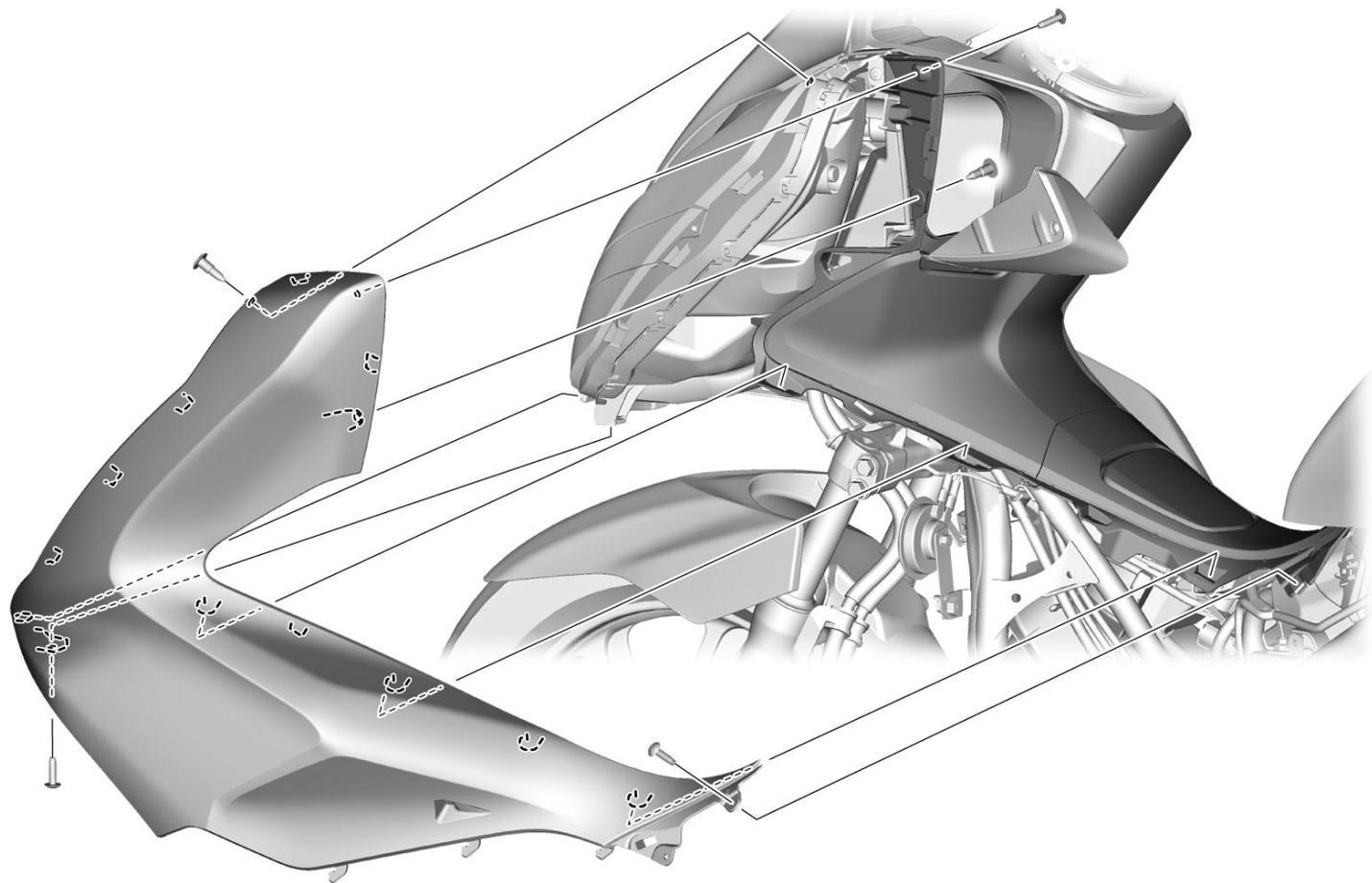
工具：小一字螺丝刀、十字螺丝刀、塑料刮板
