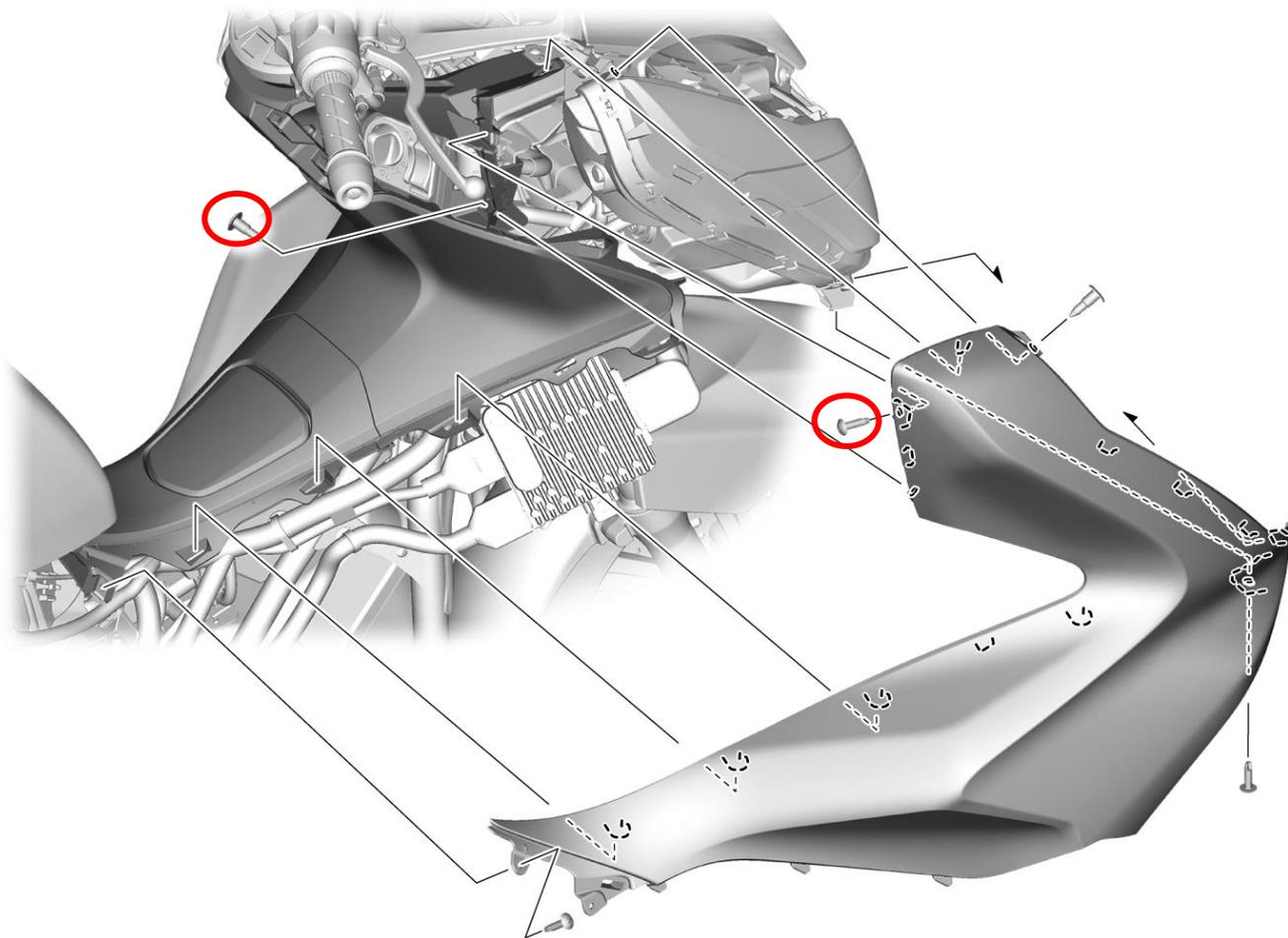
工具：小一字螺丝刀、十字螺丝刀、塑料刮板
