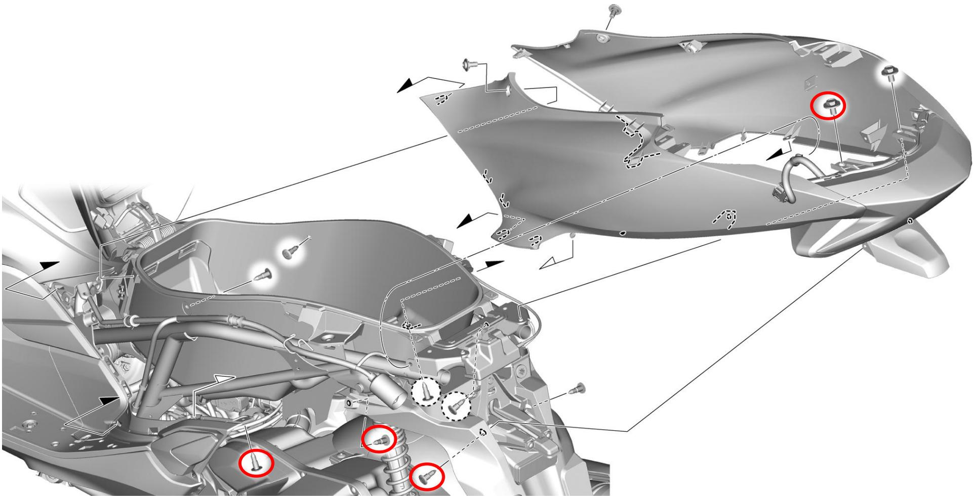
工具：小一字螺丝刀、10#T形状套筒、塑料刮板
