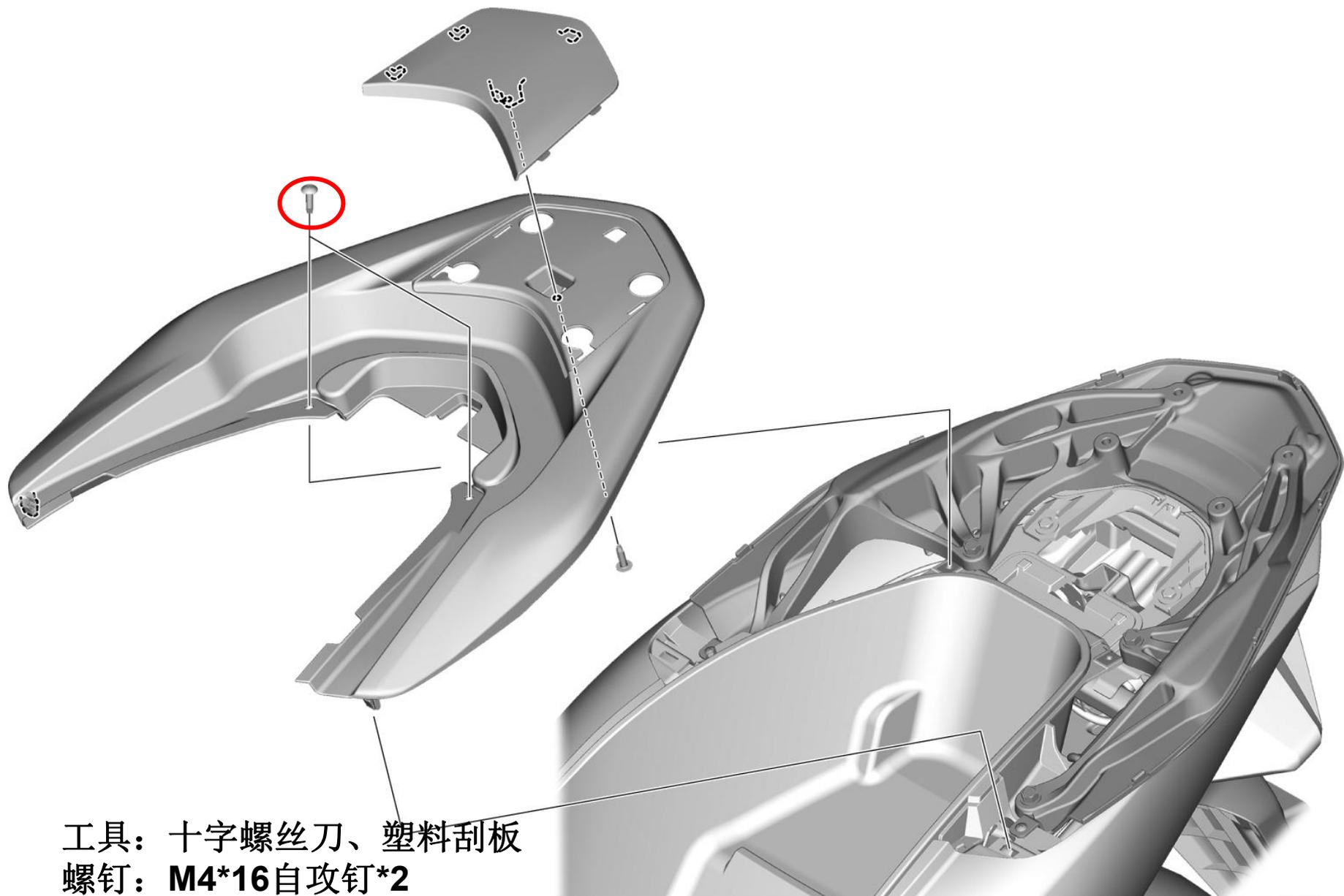
工具：十字螺丝刀、塑料刮板
