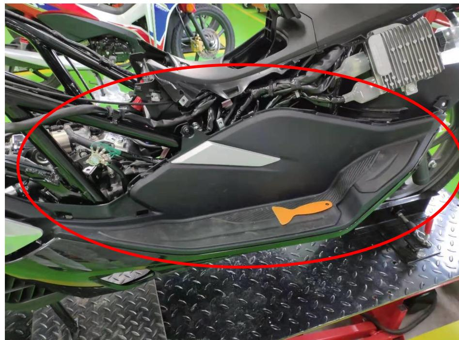
工具：小一字螺丝刀、十字螺丝刀、10#T形状套筒
