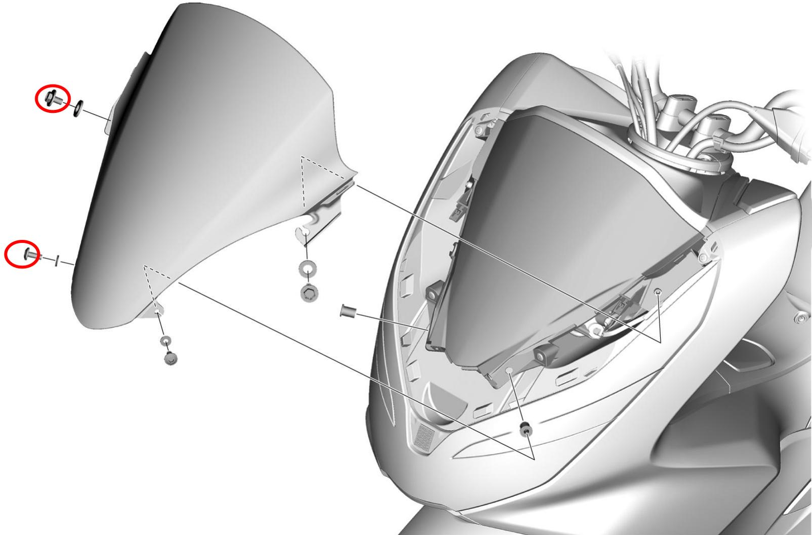
工具：内六角扳手、10#T形状套筒
